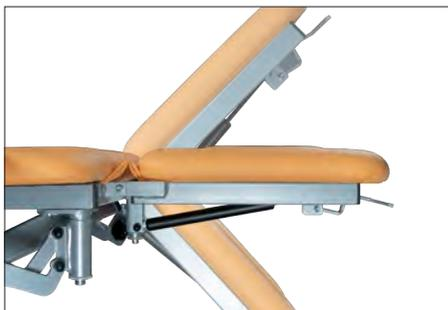
Alle Behandlungsliegen können mit einem positiv und negativ verstellbaren Kopfteil ausgestattet werden, welches per Hand ausgelöst und in seiner Funktion von einer Gasdruckfeder unterstützt wird. Durch Anheben des Auslösehebels wird die Feststellung des Kopfteils entriegelt und lässt sich je nach Bedarf stufenlos bis zu 50° nach oben und 60° nach unten verstellen. Für die Aufwärtsbewegung muss keine, für die Abwärtsbewegung je nach Belastung des Kopfteils zusätzliche Armkraft ausgeübt werden.
