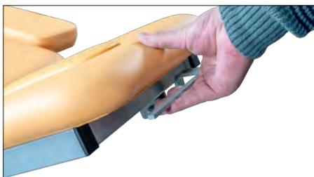
Durch Anheben des Auslösehebels wird die Gasdruckfeder entriegelt. Durch gleichzeitiges Ausüben von Druck lässt sich das Kopfteil stufenlos beliebig, jedoch maximal bis zum Anschlag, nach unten in die negative Stellung bringen. Sobald der Auslösehebel losgelassen wird verriegelt sich die Mechanik wieder, so dass das Kopfteil sofort in der gewählten Position verbleibt.
