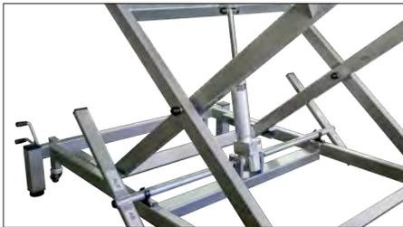
Für diese Antriebsart ist kein elektrischer Anschluß erforderlich, ebenso keine Sperrbox oder Handbedienung. Somit entfällt die durch das BfArM vorgeschriebene Absperrpflicht. Durch Betätigen des langen Endes des Fußtritthebels wird durch den Hydraulikzylinder die Liegefläche angehoben. Das Anheben des kurzen Endes des Hebels bewirkt das Absenken.
