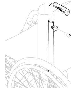
1. Um die Höhe der Schiebegriffe einzustellen, lösen Sie die Knebelschraube **(A)**, schieben den Griff auf die gewünschte Höhe, und ziehen die Knebelschraube wieder an.
