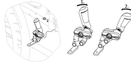
1. Zum Betätigen der Bremse drücken Sie den Bremshebel mit der Handfläche so weit wie möglich nach vorne.
