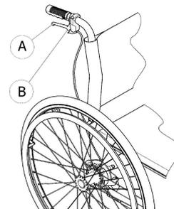
1. Ziehen Sie zum Lösen den Bremshebel **A** an der Schiebbestange.
