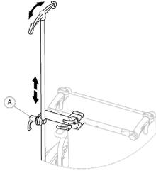
1. Lösen Sie den Hebel (A).
