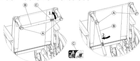
1. Lösen Sie die beiden Handschrauben **(A)**, ziehen Sie die Rückenlehnenstrebe **(B)** nach oben, und schwenken Sie sie dann entlang der Rückenlehne nach unten.
