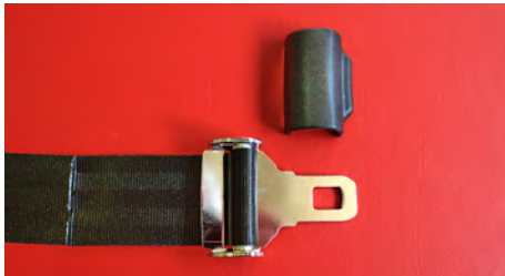
Abb. 9 Das Gurtband über den Spannblock wieder zurück durch die Gurtzunge fädeln.
