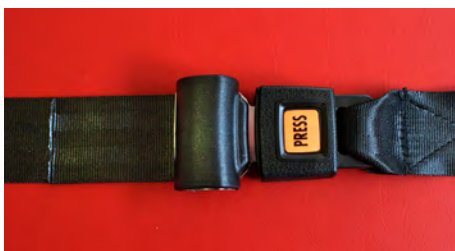
Abb. 11 Fertig montierte Gurtzunge mit eingeschnappten Gurtschloss des Polsters.
