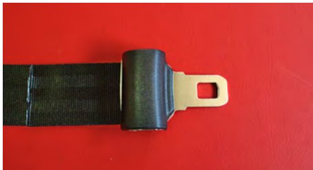
Abb. 10 Die Kunststoffkappe von oben auf die Gurtzunge aufsetzen, andrücken und einschnappen lassen.
